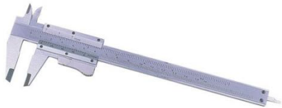
Peu de rei d'acer, tipus Vernier 150mm Aprec.0,05mm.
